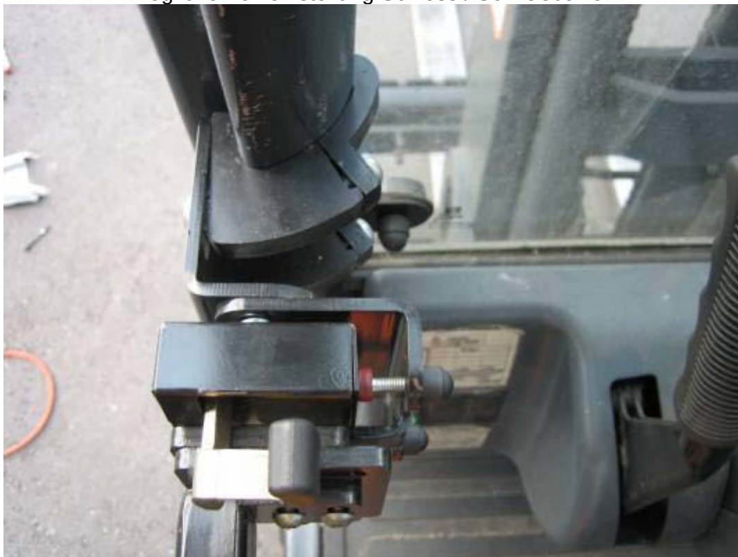
Türstopper (2 x) im geschlossenen Zustand anstellen
