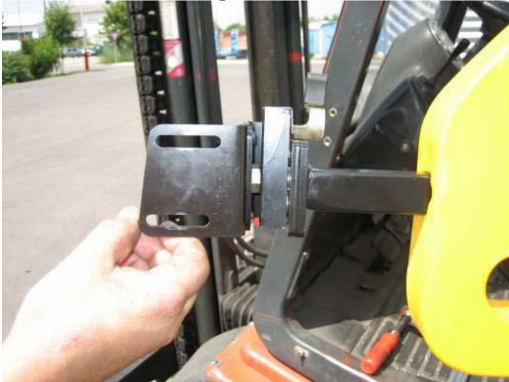
Schließbolzen in Schloss einrasten
