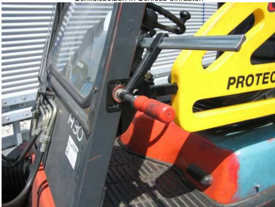
Schließbolzen in Schloss einrasten
