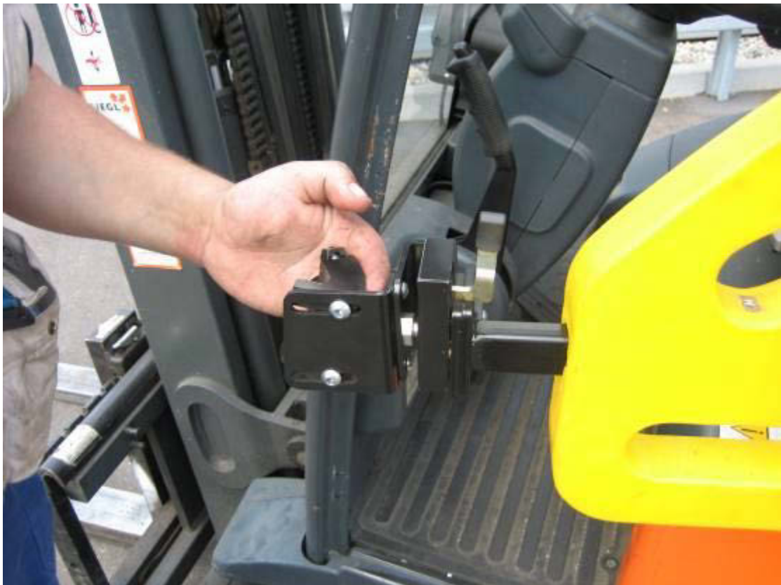
Schließbolzen in Schloss einrasten
