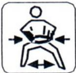
Steuerrad mit **beiden Händen festhalten** und mit den Füßen am Boden abstützen!
