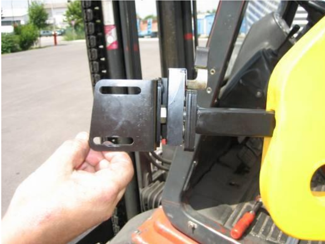
Schließbolzen in Schloss einrasten
