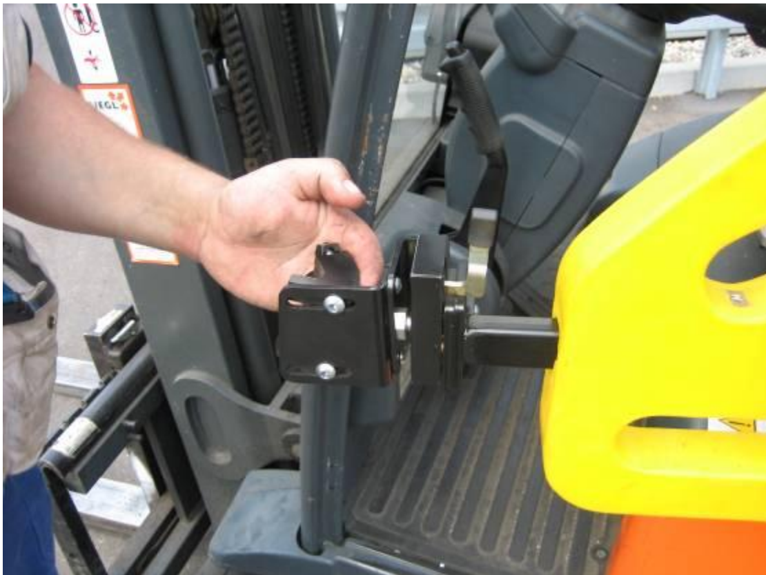
Schließbolzen in Schloss einrasten
