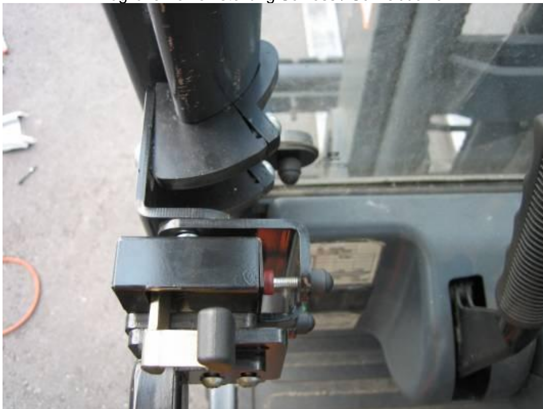
Türstopper (2 x) im geschlossenen Zustand anstellen
