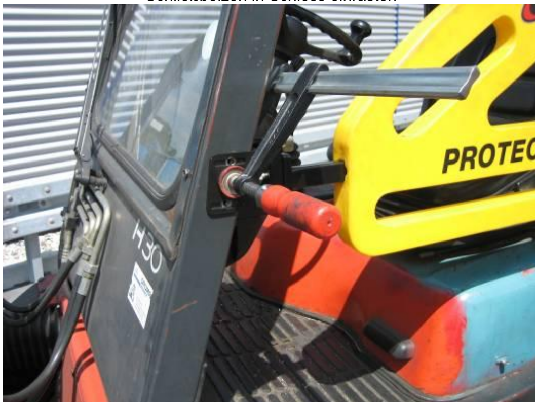
Schließbolzen in Schloss einrasten
