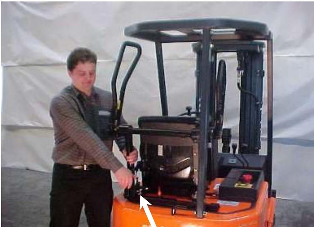
entriegeln und geöffnetes Rückhaltesystem nach links bis zum Anschlag verschieben
