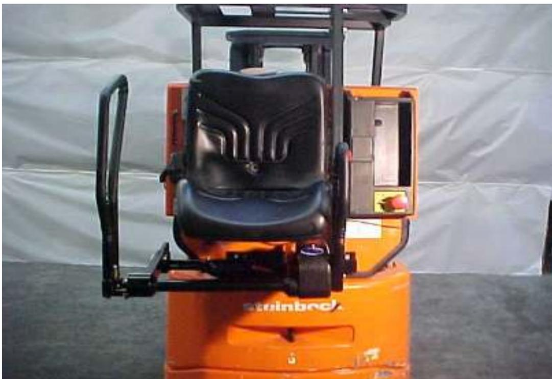
vor Öffnen der Batterieabdeckung Rückhaltesystem von Hand schließen
