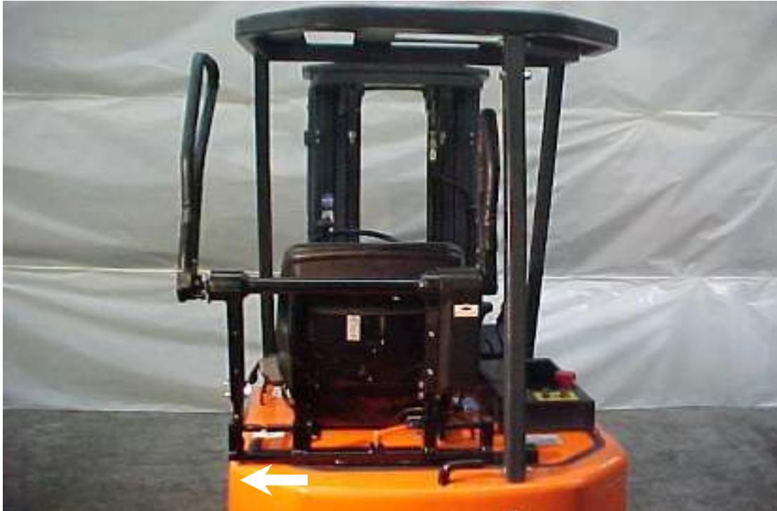
Rückhaltesystem nach links bis zum Anschlag verschieben
