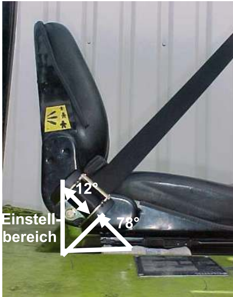
Einstellwinkel der Gurtrolle
