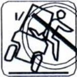
Droht das Fahrzeug zu kippen, das Rückhaltesystem geschlossen lassen und innerhalb des Fahrerschutzdaches verweilen; **Nicht abspringen!**
